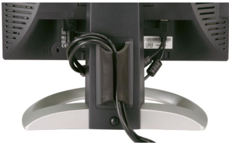
将所有必要的电缆连接到显示器和计算机后（请参阅[连接显示器](#)了解如何连线），请如下所示使用电缆固定夹将所有电缆整齐的整理在一起。
